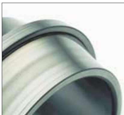
Aro interior de un rodamiento oscilante de rodillos usado
