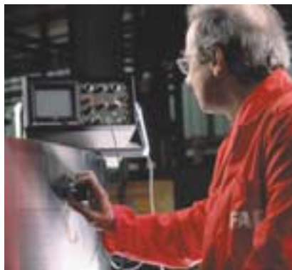
Revisión del camino de rodadura de un aro interior
