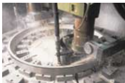
Rectificado de un aro exterior
